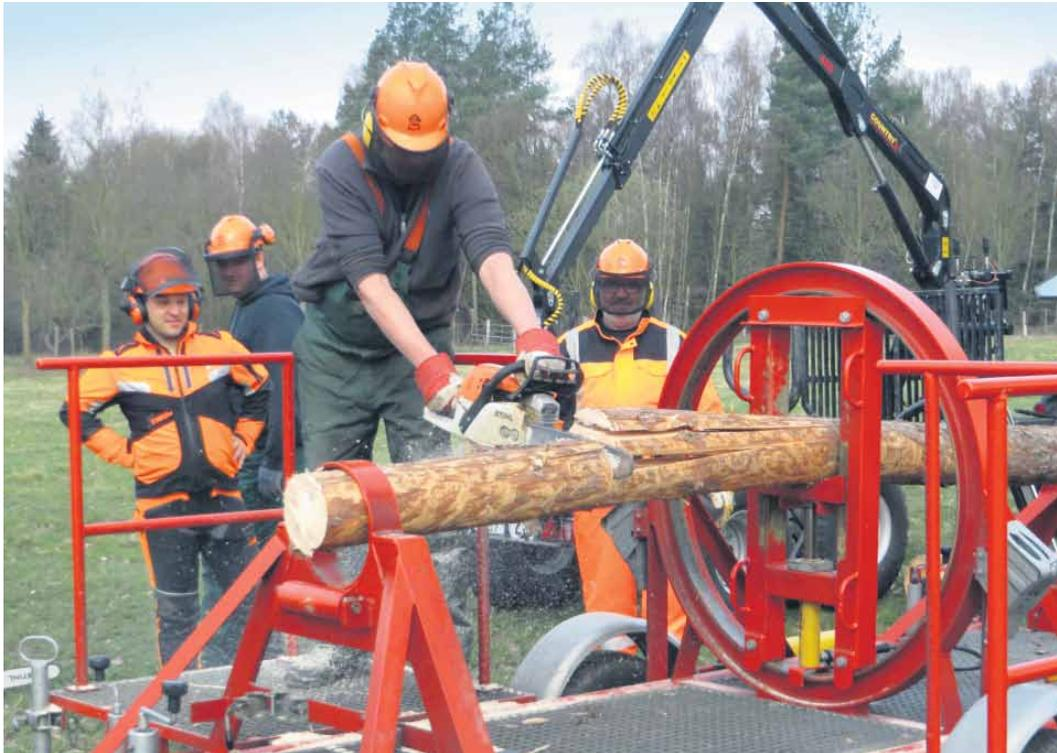
**Spannungsgeladen:** Beim Anschneiden des Stamms werden enorme Kräfte frei – deutlich sichtbar am Aufsplintern des Holzes.
